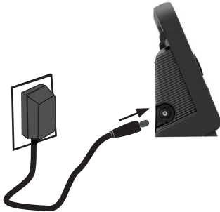
110/230 V Netzteil von Wechsel- auf Gleichstrom
