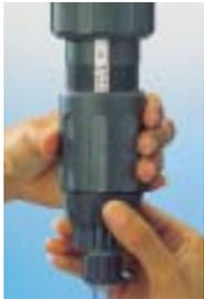
Die Einstellung der Dosierung wird durch das Drehen der Reglerschraube vorgenommen, deren oberer Rand mit dem gewünschten Wert auf der Dosierskala übereinstimmen muss. Die eingespritzte Konzentratsmenge ist proportional zum Wasservolumen, das den Dosatron durchfließt: z.B.: Einstellung auf 1% = 1 : 100 = 1 Volumen des Konzentrats plus 100 Volumen Wasser
