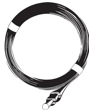
Línea de salida se refiere al sistema de alambrado que lleva la corriente eléctrica del energizador al centro de la cerca, y no solamente del energizador a la cerca. Prácticamente, mientras mas alambres conectados en paralelo mejor el voltaje en la cerca.
