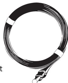
Als Zaunzuleitung versteht man das Drahtsystem welches die Energie vom Elektrozaungerät zum Zentrum des Zaunsystems leitet – nicht nur vom Elektrozaungerät zum Zaun. Prinzipiell gilt, je mehr parallel verbundene Drähte verwendet werden, desto besser ist die Spannung am Ende des Zaunes.
