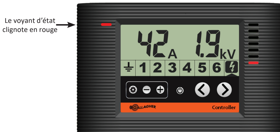
Contrôleur montrant l'électrificateur en état d'alarme
