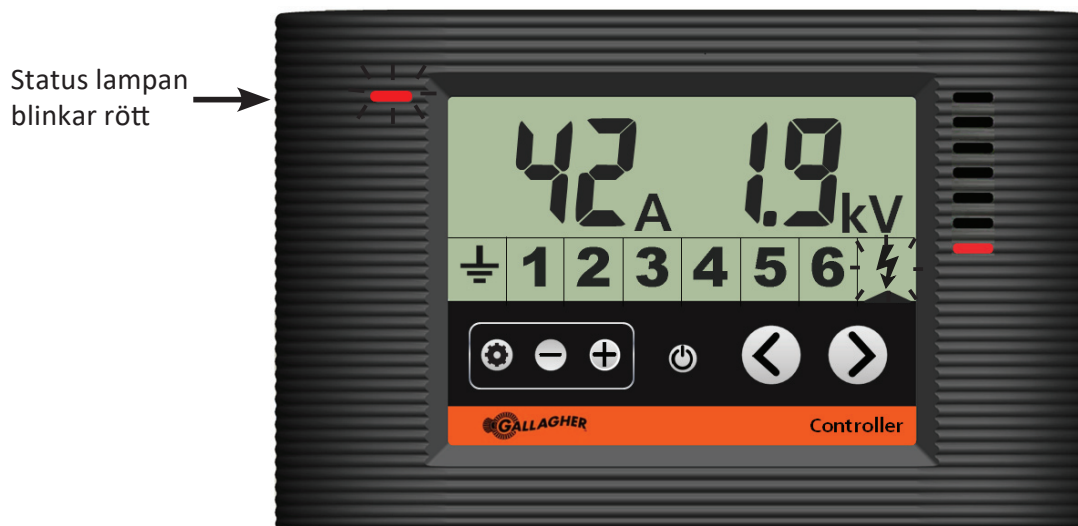
Kontrollen visar aggregat i ström larm
