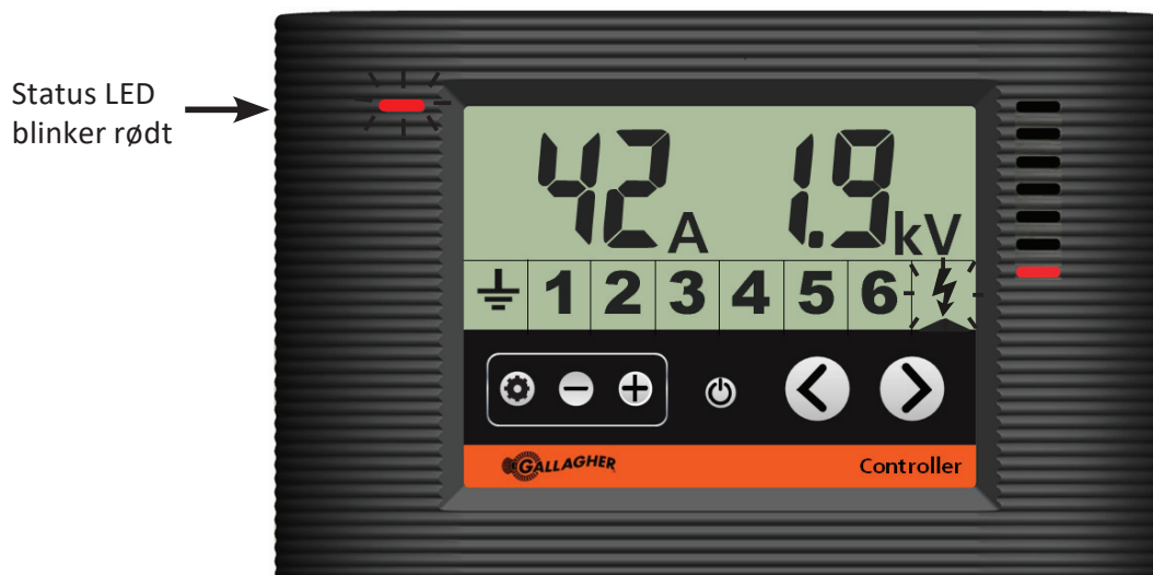
Styreenheden viser energizeren i strømstyrke alarm
