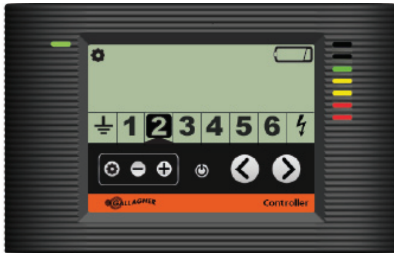
Controlador mostrando la zona 2 con batería baja
