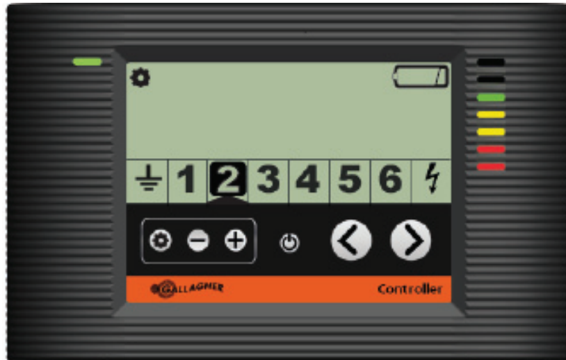
Styreenheden viser zone 2 med et lavt batteri
