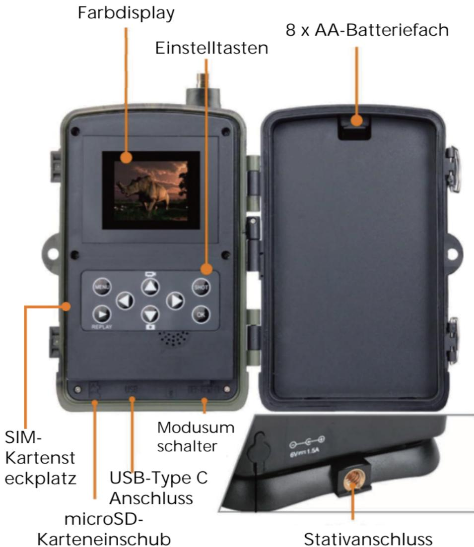
Öffnen Sie das Batteriefach, setzen Sie 8 AA-Batterien ein und achten Sie dabei auf die Polarität (+/-). Schließen Sie das Batteriefach wieder, um es vor Wasser und Staub zu schützen.
